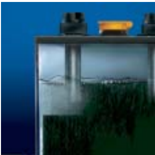
Фаза постоянного тока: малое газовыделение до напряжения 2,4 В / элемент.
